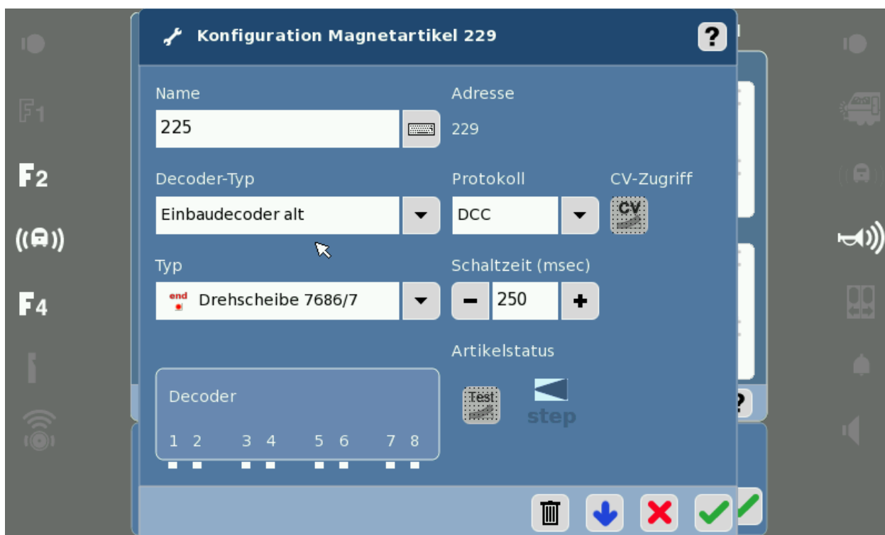
Abbildung 5: Der Drehscheibendekoder Adresse 225-240 ist als "ein Block" zu sehen. Hier wurde bereits die Adresse 229 bereits auf DCC umgestellt, was dann auch für alle Adressen 225-240 gilt.
